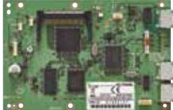
Interface contrôleur Simulcast IDAS NXDN, pour réseau conventionnel ou réseau Trunk type-D (logiciel Simulcast inclus)
